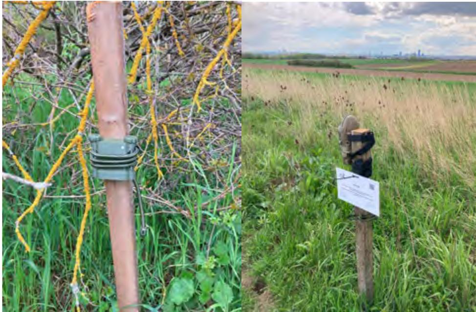
Abbildung 2 Montage der Audiorekorder (links) und Zeitrafferkameras (rechts)
